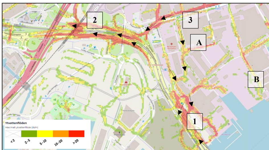
Figur 15. Befintlig skyfallssituation för område 1, maximalt ytvattenflöde vid klimatanpassat 100-årsregn. Flödesriktningar redovisas med svarta pilar.
